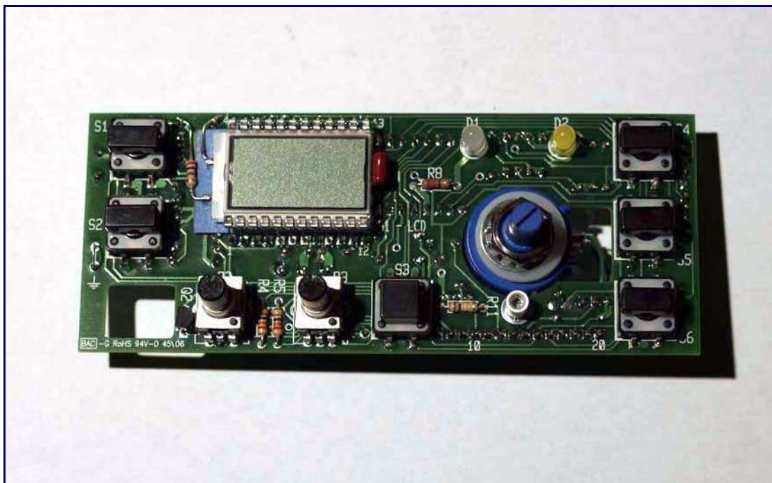
Bestückte Frontplatine. Links neben den LC Display ist ein Teil der Hintergrundbeleuchtung zu erkennen.
