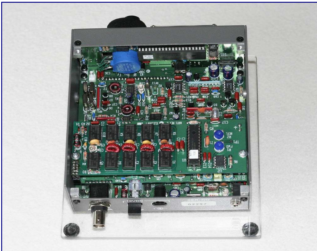
Der fertige K1 von innen. Der Antennentuner ist auch schon montiert. Er befindet sich über dem Filterboard.
