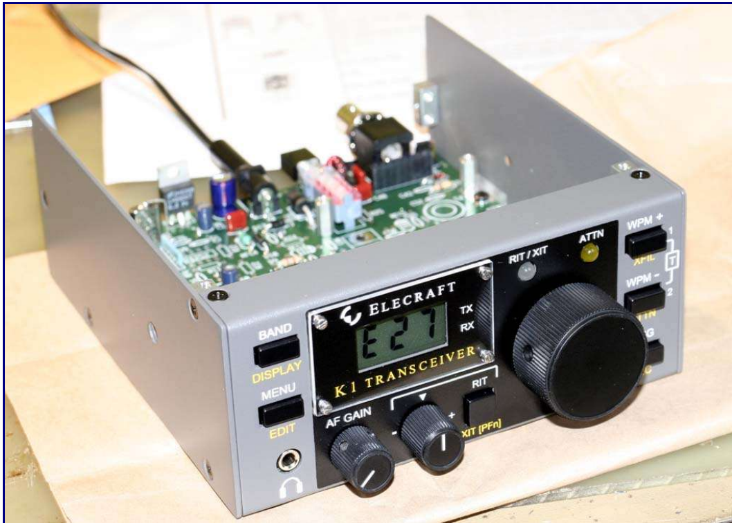
Der K1 beim ersten Funktionstest. Der VFO ist an dieser Stelle noch nicht komplett bestückt.
