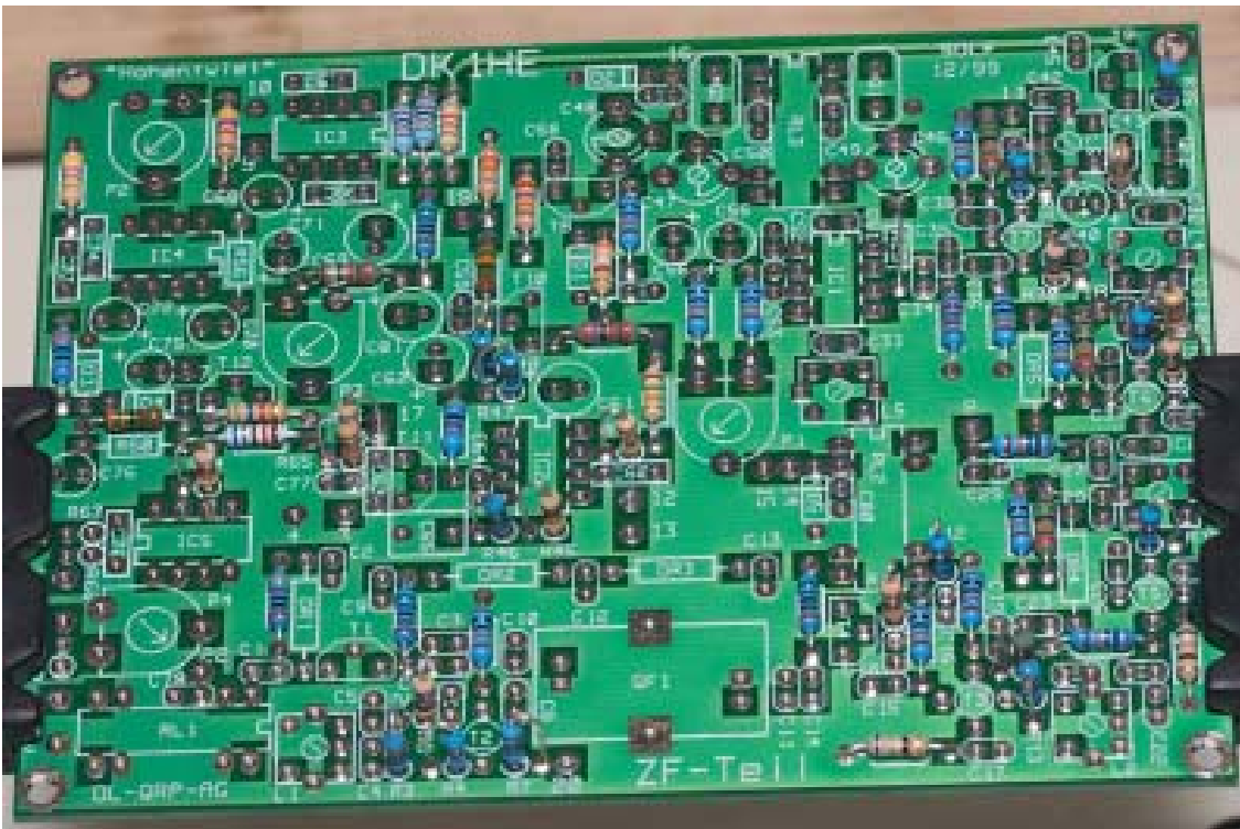
ZF Platine, Widerstände bestückt.
